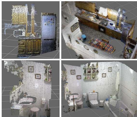
Figura 4: A la izquierda, nubes de puntos de una cocina y un cuarto de baño con información contextual limitada. A la derecha, nubes de las mismas habitaciones donde la información contextual más extensa.
